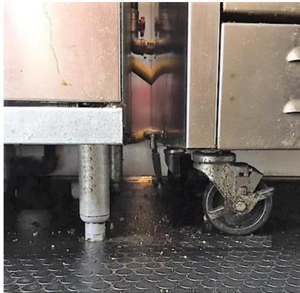
Equipo montado en el piso elevado sobre patas de 6 pulgadas o sobre ruedas para mover para la limpieza.
