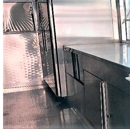
Equipos sellados entre sí, el piso y la pared posterior para evitar que se acumulen desechos debajo, detrás y entre los equipos.
